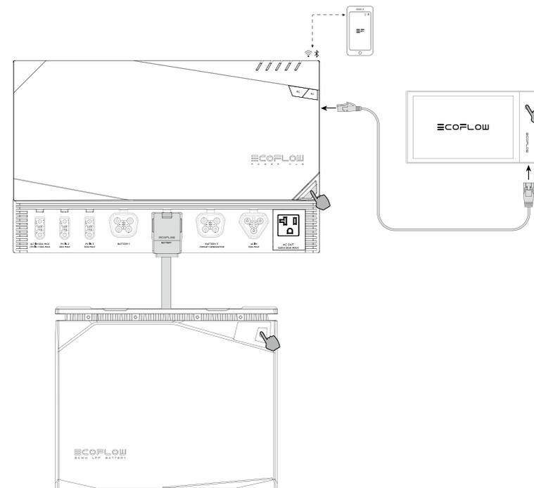
**Mise sous tension :** Appuyez sur le bouton d'alimentation et maintenez-le enfoncé pendant 2 secondes. La batterie s'allume. Appuyez brièvement sur le bouton d'alimentation pour activer l'écran. Après la mise sous tension, l'écran s'allume et indique le niveau de batterie restant.
