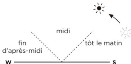
La fonction support ne doit être utilisée qu'avant 10h00 et après 14h00. Pour utiliser le produit vers midi, placez simplement le panneau solaire à plat sur le sol.
