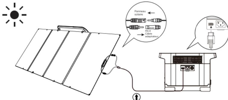
Ce câble ne peut être utilisé que pour la connexion entre les panneaux solaires et le stockage d'énergie. Il est interdit de l'utiliser pour l'interconnexion entre les panneaux solaires ou pour d'autres types de connexion.
