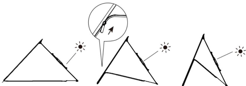
Pour obtenir de meilleurs résultats de charge, la mallette de protection peut également être utilisée en tant que support pour incliner le panneau solaire à un angle de  $40^\circ$  à  $80^\circ$ .
