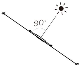
Pour recueillir l'énergie solaire le plus efficacement possible, assurez-vous que les rayons du soleil frappent le panneau à un angle de  $90^\circ$  et qu'aucune ombre ne le recouvre.
