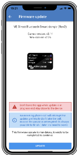
Capture d'écran de la mise à jour du micrologiciel de la clé électronique à l'aide de VictronConnect
