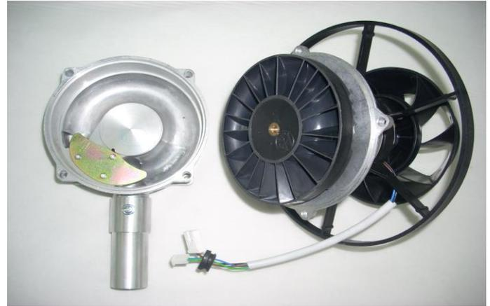
Fig.11 - Compresseur d'air
