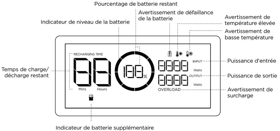
**Indicateur de niveau de la batterie** : il se remplit de façon répétée pendant la charge. Si le produit est chargé à 0 %, l'indicateur clignote pour vous avertir.
