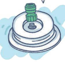
❹ Appliquer 1 pc. joint torique (H) à l'intérieur du couvercle autour du passe tuyau en laiton (A) et serrez la douille d'insert John Guest (B) sur le passe tuyau en laiton (A)
