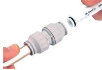
Le **démontage** est presque aussi simple: Avec vos doigts enfoncez la collerette de l'insert (voir ci-dessus, à gauche). Vous pouvez retirer le tuyau à nouveau!
