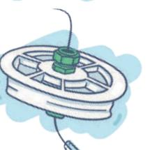
❺ Maintenant, branchez d'abord le câble de connexion (G) sur le connecteur vert (I). Voir "Connexion des fils d'alimentation au connecteur vert" Faites ensuite passer le câble de connexion (G) avec la fiche ronde à travers le trou du passe tuyau en laiton (A), à travers l'insert John Guest (B) et à travers le tuyau sur mesure (C).
