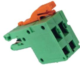
Dénudez sur 1 cm l'extrémité des deux câbles d'alimentation et torsadez les fils. Appuyez maintenant le petit tournevis fourni dans le trou inférieur droit (donc sous le clip orange), ce qui permet d'insérer le câble + (pos) dans le trou supérieur. Le câble + (pos) est le fil avec la ligne blanche. En retirant le petit tournevis, le câble + (pos) est serré. Répétez cette opération pour insérer le câble entièrement noir - (neg) sur la gauche.
