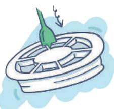
❶ Percez avec une perceuse et un forêt à bois un trou de Ø 16 mm, de préférence dans le couvercle, pour rendre le nettoyage du noyau cellulaire aussi facile que possible. Vous pouvez également choisir de placer un passage de cuve supplémentaire Ø 60 mm dans lequel ce qui précède peut ensuite être effectué.
