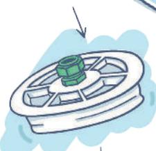
❸ Vissez le passe tuyau en laiton (A) avec le filetage le plus long dans le couvercle. Le morceau de tuyau en plastique déjà installé dans la partie supérieure du passe tuyau en laiton empêche le pincement du câble de raccordement.
